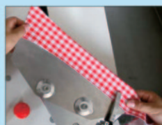
機械夾夾緊領 Automatic clamp fixing collar
