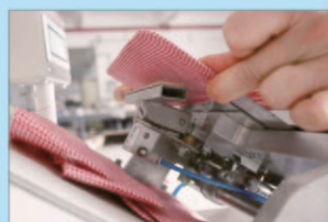
自动底夹，防止操作时袖口移位 Automatic bottom clamp for avoiding cuff shift
